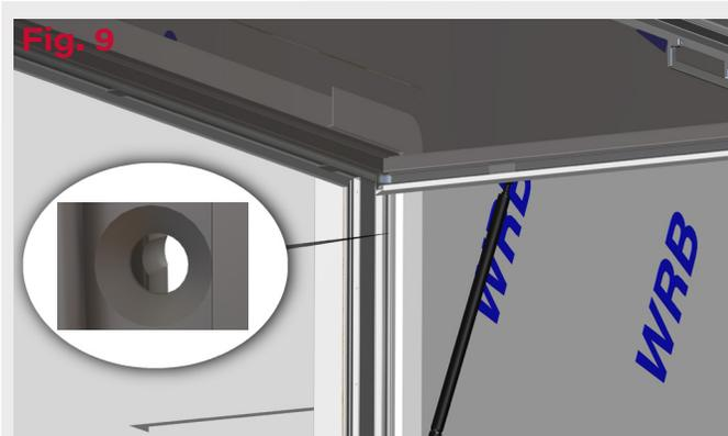
9. Utilice un taladro para avellanar y taladrar todos los orificios de anclaje a través de los marcos interiores.
