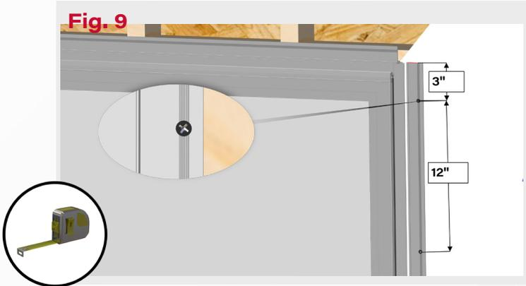
9. El primer tornillo debe estar a 3" de la esquina, seguido de 12" fuera del centro para el siguiente tornillo. Repita el paso para todas las aletas de clavo.
